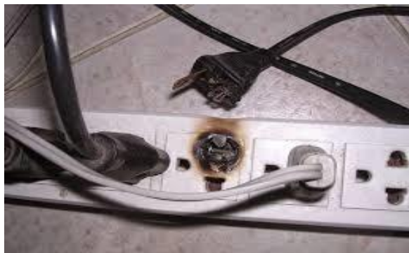
ภาพที่ 1.2 ฉนวนที่ห่อหุ้มลวดตัวนำละลายจนลุกไหม้ในที่สุด ที่มา ( http://www.thaihealth.or.th/ . สืบค้นเมื่อ 25 กันยายน 2560.)
