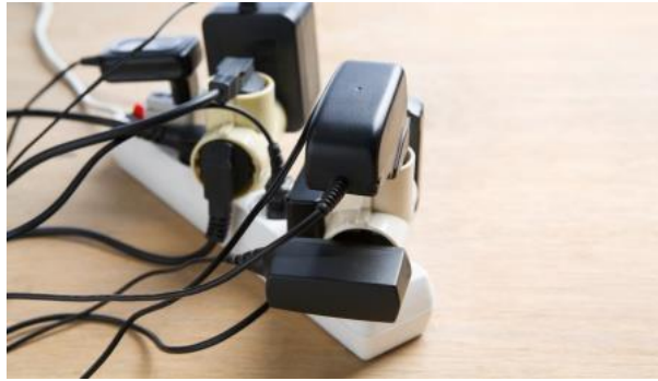
ภาพที่ 1.1 การนำอุปกรณ์ที่ใช้กำลังไฟสูงหลาย ๆ ชุดมาต่อในจุดเดียวกัน ที่มา ( http://www.thaihealth.or.th/ . สืบค้นเมื่อ 25 กันยายน 2560.)
