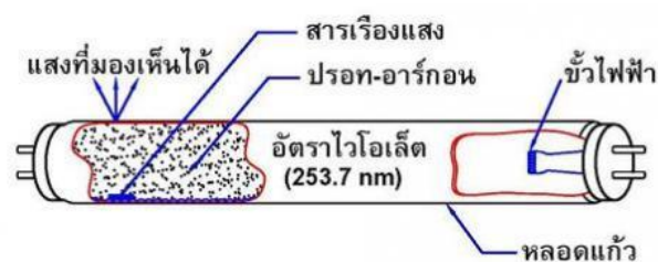
ภาพที่ 9.7 โครงสร้างและส่วนประกอบของหลอดฟลูออเรสเซนต์
