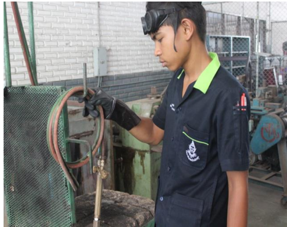
รูปที่ 1.75 แสดงลักษณะการม้วนเก็บสายยางเชื่อมแก๊สและอุปกรณ์เชื่อมแก๊ส ที่มา : นายชำนาญ ช่วยคุณูปการ , 2562
