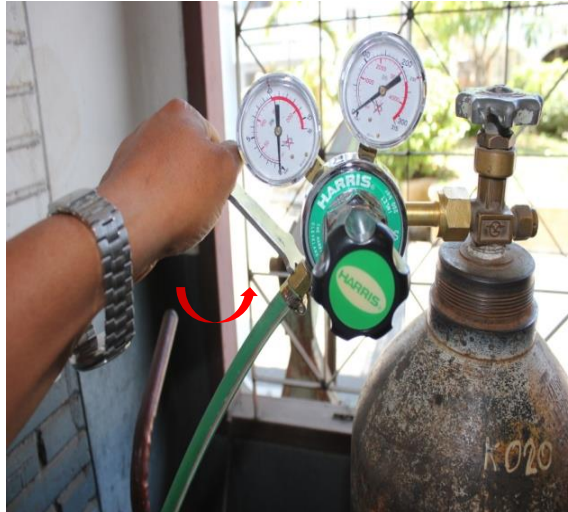
รูปที่ 1.71 แสดงลักษณะการใช้ประแจปากตายขันนัตจากสายยางเชื่อมแก๊สออกซิเจน ที่ต่อกับชุดควบคุมความดันแก๊ส ที่มา : นายชำนาญ ช่วยคุณูปการ , 2562
