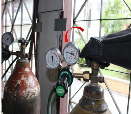
รูปที่ 1.56 แสดงลักษณะการตรวจสอบรอยรั่วของท่อบรรจุแก๊สออกซิเจน
