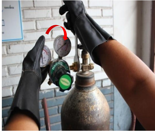
รูปที่ 1.48 แสดงลักษณะการประกอบอุปกรณ์ควบคุมความดันแก๊สออกซิเจน ที่มา : นายชำนาญ ช่วยคุณูปการ , 2562
