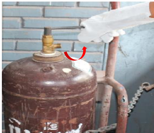
รูปที่ 1.49 แสดงลักษณะการเปิดวาล์วที่หัวท่อบรรจุแก๊สอะเซทิลีน ที่มา : นายชำนาญ ช่วยคุณูปการ , 2562
