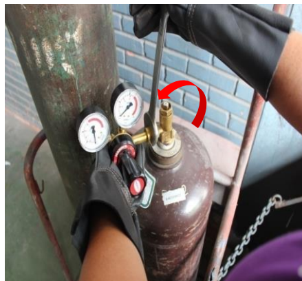
รูปที่ 1.74 แสดงลักษณะการใช้ประแจปากตายขันนัตที่เกลียวข้อต่อแก๊ส เข้ากับชุดควบคุมความดันแก๊สอะเซทิลีน ที่มา : นายชำนาญ ช่วยคุณูปการ , 2562
