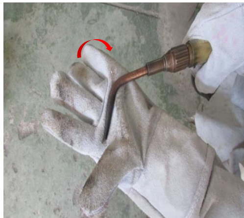
รูปที่ 1.55 แสดงลักษณะการนำหัวตีพม่าประกอบเข้ากับห้องผสมแก๊ส ที่มา : นายชำนาญ ช่วยคุณูปการ , 2562
