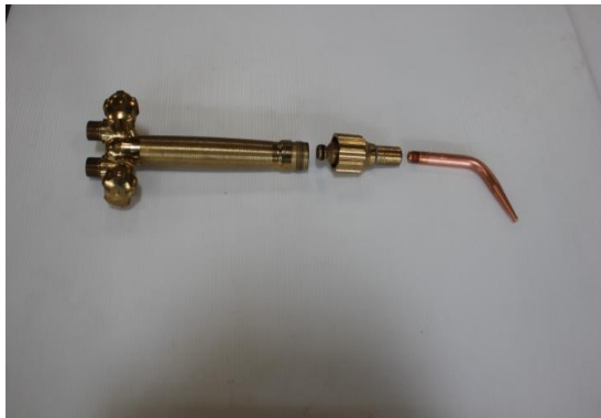
รูปที่ 1.70 แสดงลักษณะการคลายหัวเชื่อมแก๊ส ที่มา : นายชำนาญ ช่วยคุณูปการ , 2562
