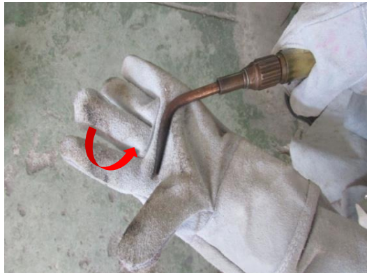
รูปที่ 1.69 แสดงลักษณะการคลายหัวทิพออกจากหัวเชื่อมแก๊ส ที่มา : นายชำนาญ ช่วยคุณูปการ , 2562
