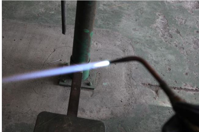
รูปที่ 1.18 แสดงลักษณะการเปิดแก๊สจากหัวเชื่อมทิ้งไว้ ที่มา : นายชำนาญ ช่วยคุณูปการ , 2562
