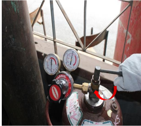
รูปที่ 1.59 แสดงลักษณะการใช้ประแจเปิดวาล์วหัวท่อบรรจุแก๊สอะเซทิลีน ที่มา : นายชำนาญ ช่วยคุณูปการ , 2562
