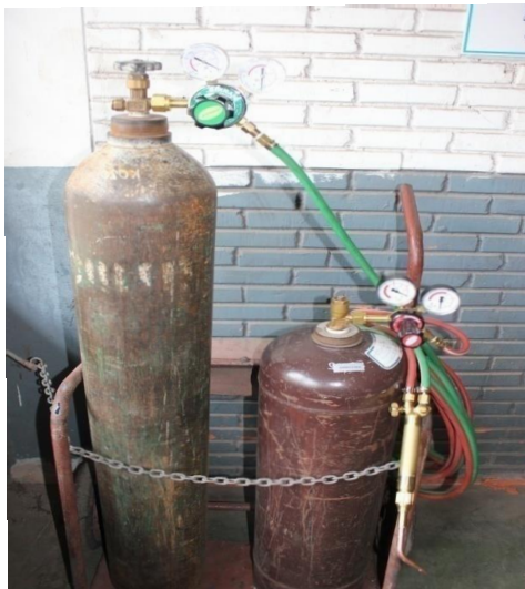
รูปที่ 1.5 แสดงลักษณะการยึดท่อบรรจุแก๊สออกซิเจนและแก๊สอะเซทิลีนด้วยโซ่ ที่มา : นายชำนาญ ช่วยคุณูปการ , 2562
