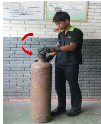
(ข) ถอดฝาครอบหัวท่อบรรจุแก๊สอะเซทิลีน
