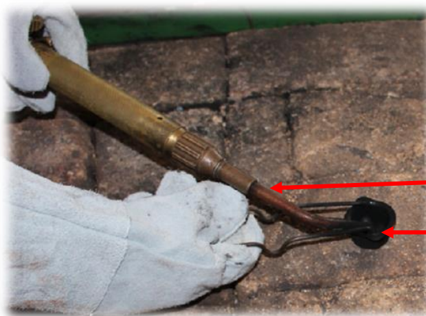
รูปที่ 1.17 แสดงลักษณะการจุดเปลวไฟเชื่อมแก๊สแบบถูกต้องวิธี ที่มา : นายชำนาญ ช่วยคุณูปการ , 2562
