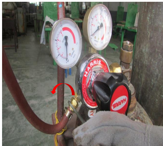
รูปที่ 1.72 แสดงลักษณะการใช้ประแจปากตายขันนัตจากสายยางเชื่อมแก๊ส อะเซทิลีนที่ต่อกับชุดควบคุมความดันแก๊ส ที่มา : นายชำนาญ ช่วยคุณูปการ , 2562
