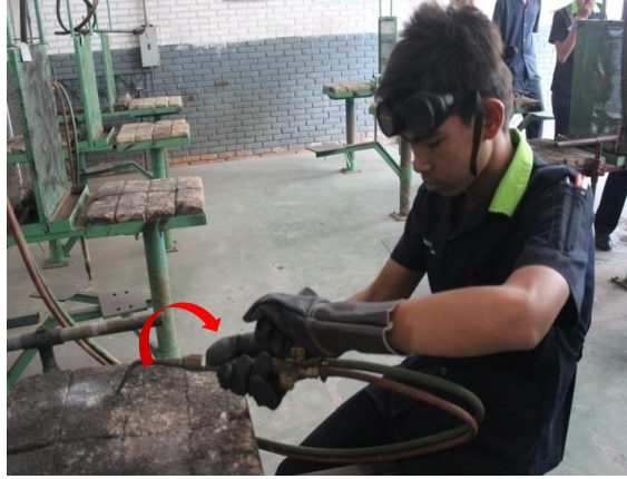
รูปที่ 1.67 แสดงลักษณะการปิดวาล์วแก๊สออกซิเจนที่หัวเชื่อมแก๊ส ที่มา : นายชำนาญ ช่วยคุณูปการ , 2562
