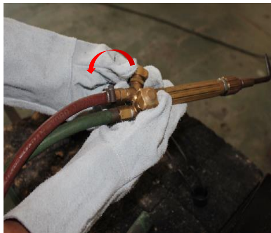
รูปที่ 1.68 แสดงลักษณะการเปิดวาล์วแก๊สอะเซทิลีนที่หัวเชื่อมแก๊ส ที่มา : นายชำนาญ ช่วยคุณูปการ , 2562
