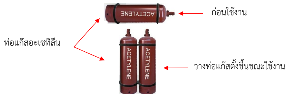
รูปที่ 1.8 แสดงลักษณะการวางท่อแก๊สตั้งขึ้นควรให้สารอะซีโตนจัดระเบียบให้ดีก่อนเปิดใช้งาน
