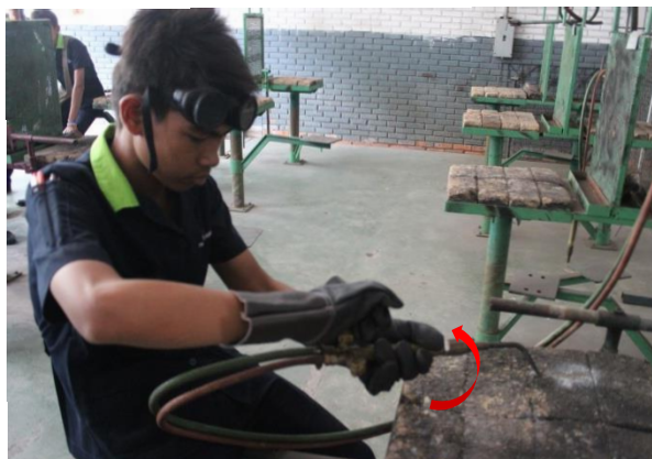
รูปที่ 1.66 แสดงลักษณะการเปิดวาล์วแก๊สออกซิเจนที่หัวเชื่อมแก๊ส ที่มา : นายชำนาญ ช่วยคุณูปการ , 2562
