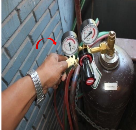
รูปที่ 1.52 แสดงลักษณะการประกอบสายยางเชื่อมแก๊สอะเซทิลีน ที่มา : นายชำนาญ ช่วยคุณูปการ , 2562
