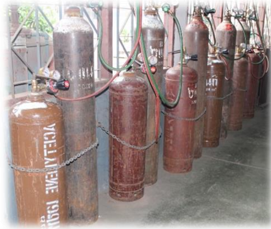
รูปที่ 1.4 แสดงลักษณะการยึดท่อบรรจุแก๊สออกซิเจนและแก๊สอะเซทิลีนด้วยโซ่ ที่มา : นายชำนาญ ช่วยคุณูปการ , 2562
