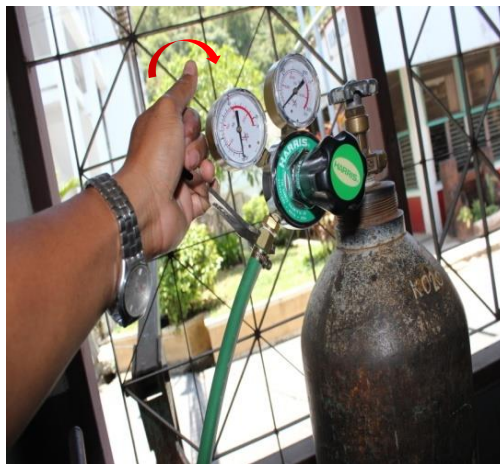
รูปที่ 1.51 แสดงลักษณะการประกอบสายยางเชื่อมแก๊สออกซิเจน ที่มา : นายชำนาญ ช่วยคุณูปการ , 2562
