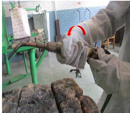
รูปที่ 1.58 แสดงลักษณะการเปิดวาล์วแก๊สออกซิเจนที่หัวเชื่อมแก๊ส
