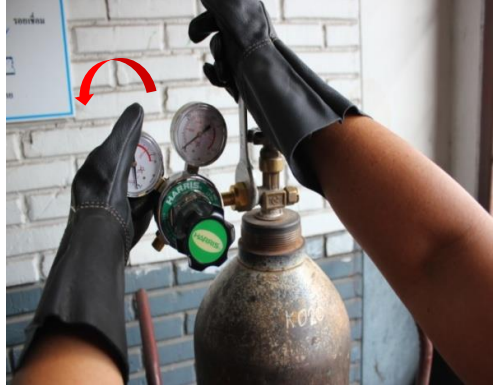
รูปที่ 1.73 แสดงลักษณะการใช้ประแจปากตายขันนัตที่เกลียวข้อต่อแก๊ส เข้ากับชุดควบคุมความดันแก๊สออกซิเจน ที่มา : นายชำนาญ ช่วยคุณูปการ , 2562
