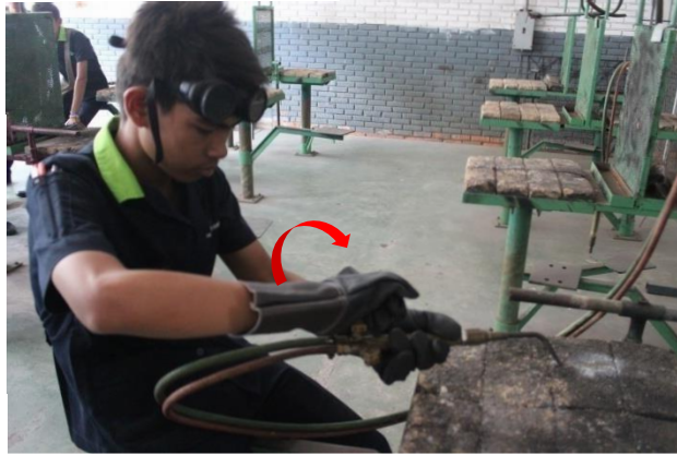
รูปที่ 1.63 แสดงลักษณะการปิดวาล์วแก๊สออกซิเจนที่หัวเชื่อมแก๊ส ที่มา : นายชำนาญ ช่วยคุณูปการ , 2562
