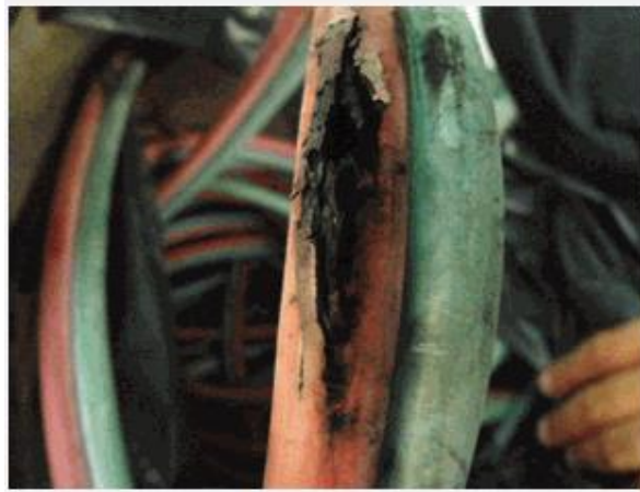
รูปที่ 1.14 แสดงลักษณะสายยางเชื่อมแก๊สที่ชำรุด ที่มา : นายชำนาญ ช่วยคุณูปการ , 2562
