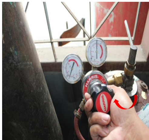
รูปที่ 1.60 แสดงลักษณะการหมุนสกรูปรับความดันแก๊สอะเซทิลีน ที่มา : นายชำนาญ ช่วยคุณูปการ , 2562
