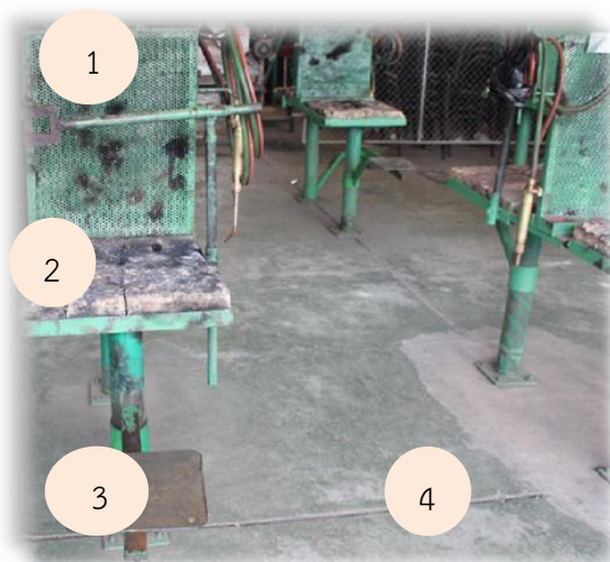
รูปที่ 1.3 แสดงลักษณะส่วนประกอบโต๊ะฝึกงานเชื่อมแก๊ส ที่มา : นายชำนาญ ช่วยคุณูปการ , 2562
