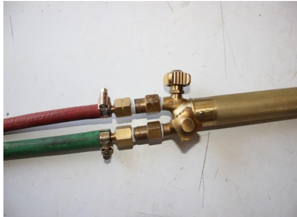
รูปที่ 1.54 แสดงลักษณะอุปกรณ์ห้องผสมแก๊สมาต่อเข้ากับหัวเชื่อมแก๊ส ที่มา : นายชำนาญ ช่วยคุณูปการ , 2562
