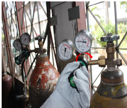
รูปที่ 1.57 แสดงลักษณะการหมุนสกรูปรับความดันแก๊สออกซิเจน
