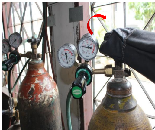
รูปที่ 1.64 แสดงลักษณะการปิดวาล์วที่หัวท่อบรรจุแก๊สออกซิเจน ที่มา : นายชำนาญ ช่วยคุณูปการ , 2562
