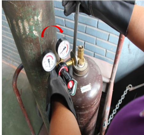
รูปที่ 1.50 แสดงลักษณะการประกอบอุปกรณ์ควบคุมความดันแก๊สอะเซทิลีน ที่มา : นายชำนาญ ช่วยคุณูปการ , 2562
