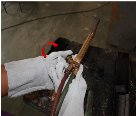
รูปที่ 1.62 แสดงลักษณะการปิดวาล์วแก๊สอะเซทิลีนที่หัวเชื่อมแก๊ส ที่มา : นายชำนาญ ช่วยคุณูปการ , 2562
