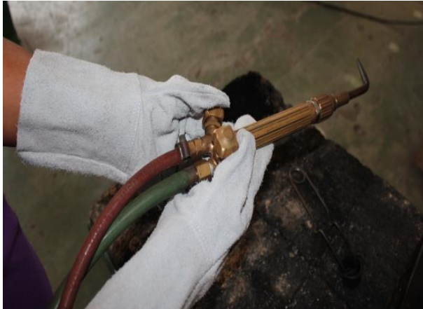
รูปที่ 1.61 แสดงลักษณะการเปิดวาล์วแก๊สอะเซทิลีนที่หัวเชื่อมแก๊ส ที่มา : นายชำนาญ ช่วยคุณูปการ , 2562
