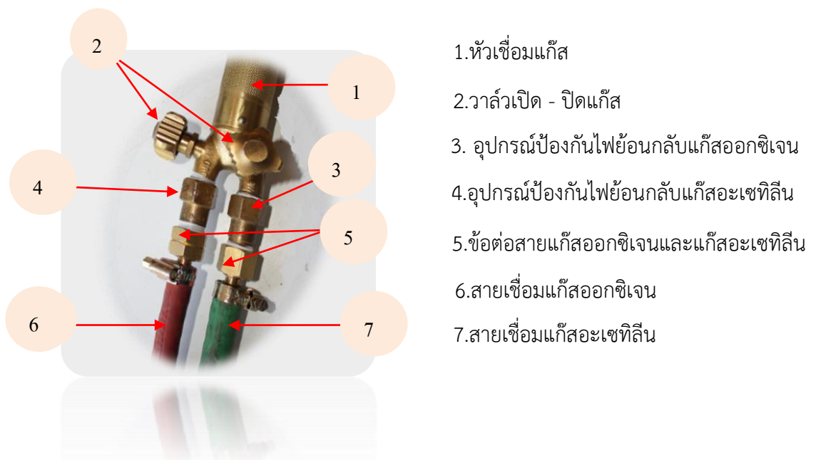
รูปที่ 1.43 แสดงลักษณะอุปกรณ์ป้องกันไฟย้อนกลับและการประกอบเข้ากับอุปกรณ์เชื่อมแก๊ส ที่มา : นายชำนาญ ช่วยคุณูปการ , 2562
