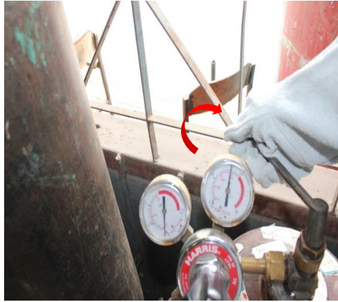
รูปที่ 1.65 แสดงลักษณะการปิดวาล์วที่หัวท่อบรรจุแก๊สอะเซทิลีน ที่มา : นายชำนาญ ช่วยคุณูปการ , 2562
