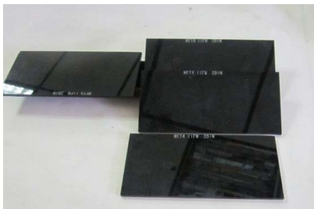
รูปที่ 2.47 ลักษณะกระจกป้องกันแสง และการใช้กระจกกรองแสง
