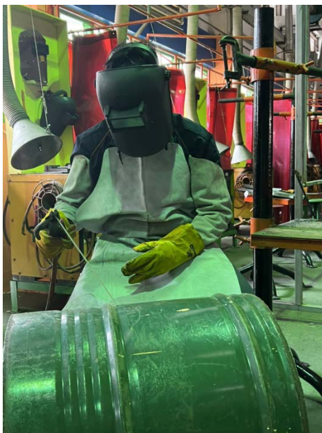
รูปที่ 2.2 แสดงการเชื่อมถังน้ำมัน โดยภายในถังไม่มีสารไวไฟตกค้างอยู่
