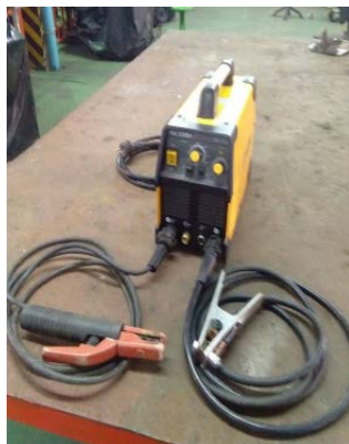
รูปที่ 2.3 แสดงสายไฟเชื่อมจะต้องอยู่ในสภาพดี
