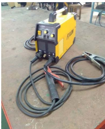
รูปที่ 2.41 เครื่องเชื่อมอินเวอร์เตอร์
