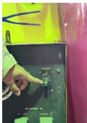
รูปที่ 2.8 เมื่อทำงานเชื่อมเสร็จ ต้องปิดสวิตซ์ที่จ่ายไฟไปยังเครื่องเชื่อม
