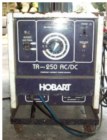
รูปที่ 2.38 เครื่องเชื่อมแบบผสมหม้อแปลง- เครื่องเรียงกระแส
