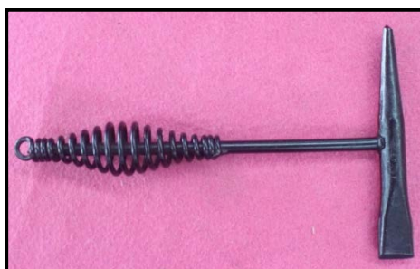
รูปที่ 2.48 ลักษณะค้อนเคาะสแลก
