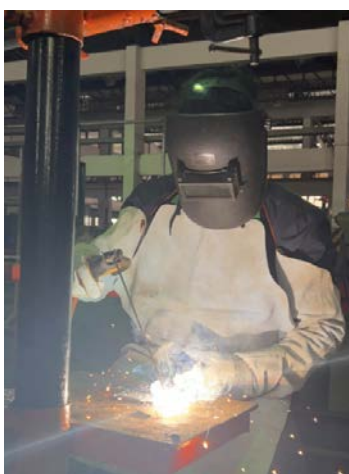
รูปที่ 2.9 แสดงการป้องกันอันตรายจากการเชื่อม
