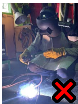
รูปที่ 2.12 ลักษณะปฏิบัติงานในท่าทางที่ไม่ถูกต้อง
