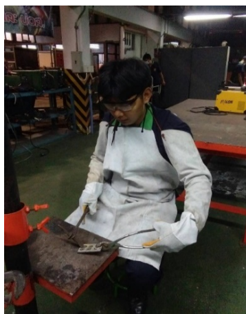
รูปที่ 2.20 แสดงสวมแว่นตานิรภัยเมื่อเคาะสแลก
