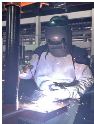
รูปที่ 2.19 แสดงสวมหน้ากากเชื่อมทุกครั้งที่ปฏิบัติงานเชื่อม
