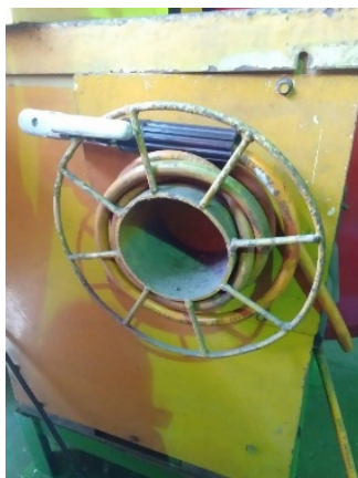
รูปที่ 2.24 แสดงเมื่อเชื่อมเสร็จควรเก็บสายเชื่อมแยกจากกันให้เรียบร้อย
