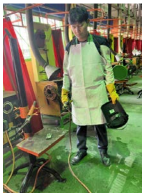
รูปที่ 2.5 แสดงกรณีที่ต้องเชื่อมในที่เปียกชื้น ต้องสวมรองเท้ายาง
