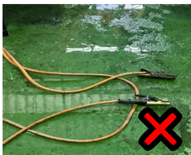
รูปที่ 2.4 แสดงขณะที่ทำงานอยู่ สายไฟเชื่อมจะต้องไม่แช่น้ำ
