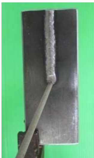
รูปที่ 2.4 แสดงลักษณะการเชื่อมทำตั้งเชื่อมลง
