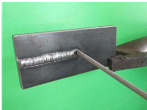
รูปที่ 2.2 แสดงลักษณะการเชื่อมทำขนานนอน
