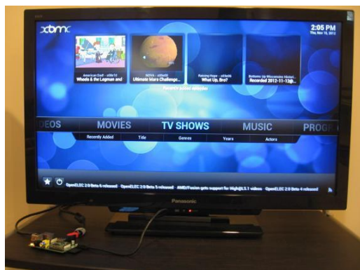
รูปที่ 1.14 ตัวอย่างการประยุกต์ใช้ Raspberry Pi เป็น Smart TV
