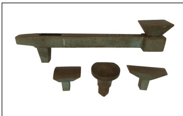
รูปที่ 1.59 แสดงลักษณะเครื่องขึ้นรูปตะเข็บสองชั้นกับหัวขึ้นรูป 4 หัว (Double Seaming Stake With Four Heads) (ที่มา : พรทิพย์ ชูแสง. 2562.)
