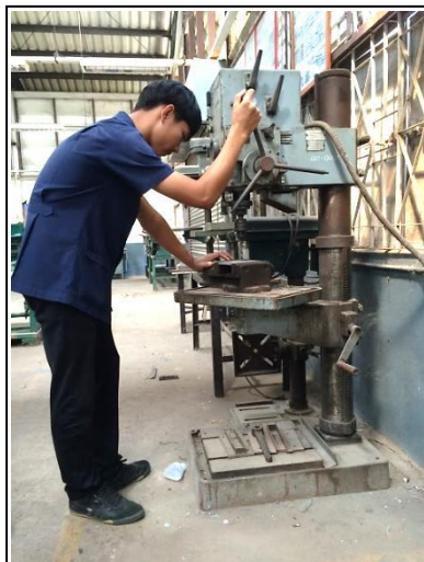
รูปที่ 1.7 แสดงการจับชิ้นงานเจาะด้วยปากกาจับงานเพื่อป้องกันอันตรายจากชิ้นงานหลุดมือ (ที่มา : พรทิพย์ ชูแสง. 2562.)
