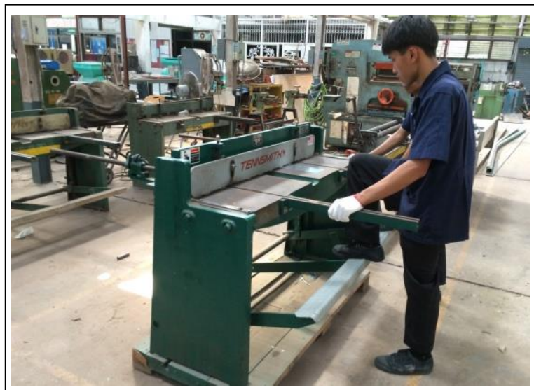
รูปที่ 1.9 แสดงการยืน การวางมือและเท้าที่ถูกต้องขณะใช้เครื่องตัดแบบใช้เท้าเหยียบ (ที่มา : พรทิพย์ ชูแสง. 2562.)
