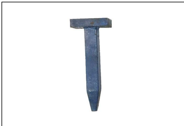
รูปที่ 1.50 แสดงลักษณะเครื่องมือขึ้นรูปคอมมอนสแควร์ (Common Square Stake) (ที่มา : พรทิพย์ ชูแสง. 2562.)
