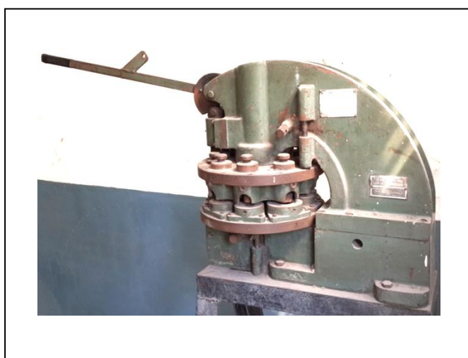
รูปที่ 1.32 แสดงลักษณะของชุดกดเจาะด้วยมือ (ที่มา : พรทิพย์ ชูแสง. 2562.)
