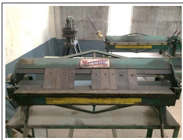
รูปที่ 1.63 แสดงลักษณะเครื่องพับกล่อง (Box and Pan Brake) (ที่มา : พรทิพย์ ชูแสง. 2562.)
