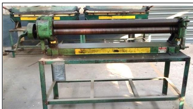
รูปที่ 1.65 แสดงลักษณะเครื่องม้วนขึ้นรูปโลหะแผ่น (Slip-Roll Forming Machine) (ที่มา : พรทิพย์ ชูแสง. 2562.)
