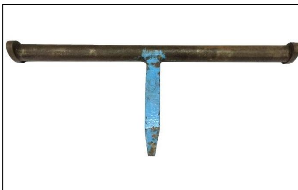
รูปที่ 1.55 แสดงลักษณะเครื่องมือขึ้นรูปตะเข็บสองชั้น (Double Seaming Stake) (ที่มา : พรทิพย์ ชูแสง. 2562.)
