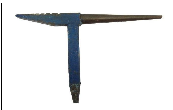
รูปที่ 1.53 แสดงลักษณะเครื่องมือขึ้นรูปครีซซิง (Creasing Stake) (ที่มา : พรทิพย์ ชูแสง. 2562.)
