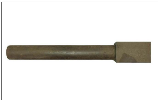
รูปที่ 1.54 แสดงลักษณะเครื่องมือขึ้นรูปฮอลโลแมนเดล (Hollow Mandrel Stake) (ที่มา : พรทิพย์ ชูแสง. 2562.)
