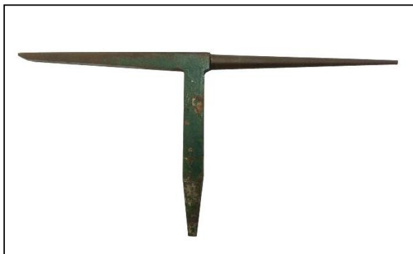
รูปที่ 1.52 แสดงลักษณะเครื่องมือขึ้นรูปนิตเดิลเคส (Needlecase Stake) (ที่มา : พรทิพย์ ชูแสง. 2562.)
