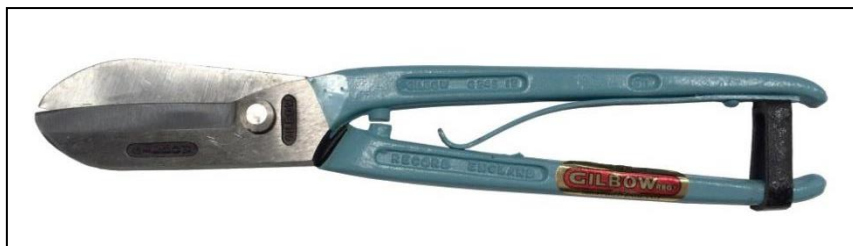
รูปที่ 1.21 แสดงลักษณะของกรรไกรตัดตรง (Straight Snips) (ที่มา : พรทิพย์ ชูแสง. 2562.)
