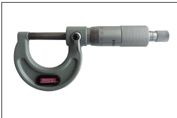
รูปที่ 1.16 แสดงลักษณะของไมโครมิเตอร์ (ที่มา : พรทิพย์ ชูแสง. 2562.)
