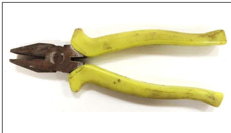
รูปที่ 1.40 แสดงลักษณะของคีมปากแบน (ที่มา : พรทิพย์ ชูแสง. 2562.)
