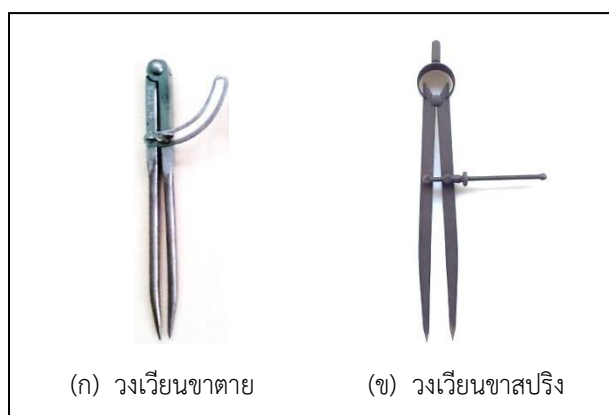
รูปที่ 1.18 แสดงลักษณะของวงเวียนขาคายและวงเวียนขาสปริง (ที่มา : พรทิพย์ ชูแสง. 2562.)
