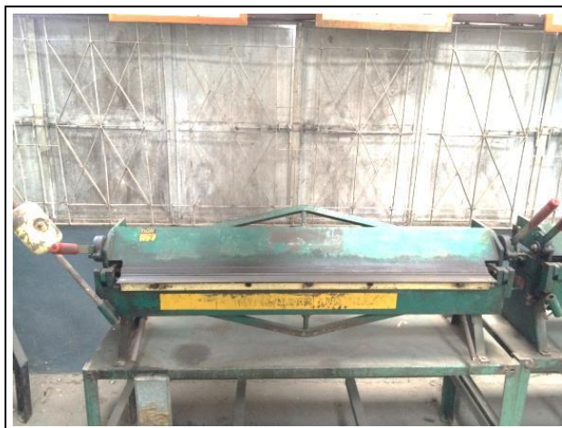
รูปที่ 1.62 แสดงลักษณะเครื่องพับด้วยมือแบบมาตรฐาน (Standard Hand Brake) (ที่มา : พรทิพย์ ชูแสง. 2562.)
