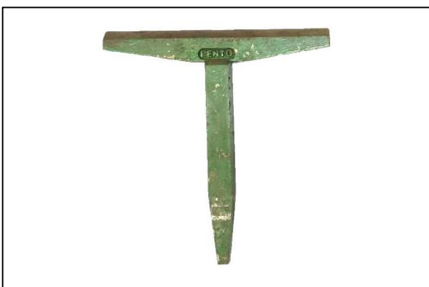
รูปที่ 1.57 แสดงลักษณะเครื่องมือขึ้นรูปคดมิต (Hatchet Stake) (ที่มา : พรทิพย์ ชูแสง. 2562.)
