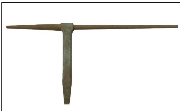
รูปที่ 1.47 แสดงลักษณะเครื่องมือขึ้นรูปแคนเดิลโมลด์ (Candle Mold Stake) (ที่มา : พรทิพย์ ชูแสง. 2562.)
