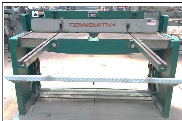
รูปที่ 1.60 แสดงลักษณะเครื่องตัดตรงชนิดป้อนแรงด้วยเท้า (Squaring Shear) (ที่มา : พรทิพย์ ชูแสง. 2562.)
