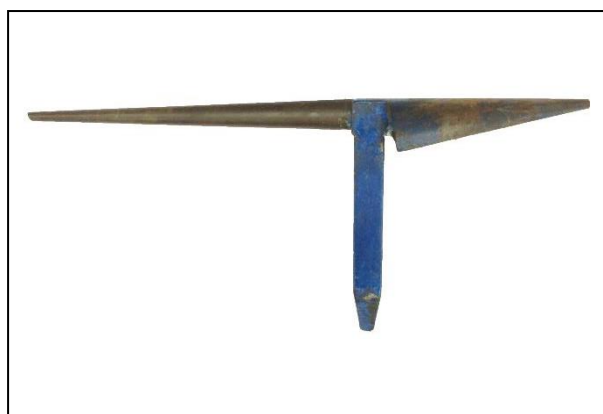
รูปที่ 1.49 แสดงลักษณะเครื่องมือขึ้นรูปโบลฮอร์น (Blowhorn Stake) (ที่มา : พรทิพย์ ชูแสง. 2562.)
