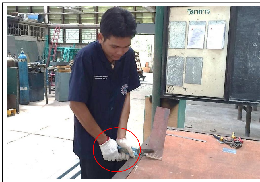
รูปที่ 1.6 แสดงการใช้กรรไกรตัดโลหะแผ่นที่มีความหนามาก อาจได้รับอันตรายจากด้ามกรรไกรหนีบมือ (ที่มา : พรทิพย์ ชูแสง. 2562.)
