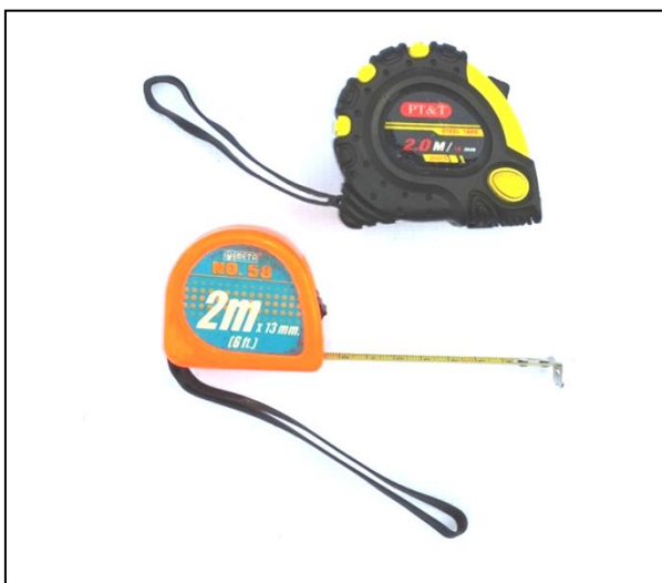
รูปที่ 1.14 แสดงลักษณะของตลับเมตร (ที่มา : พรทิพย์ ชูแสง. 2562.)
