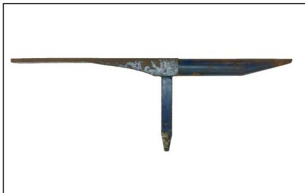
รูปที่ 1.48 แสดงลักษณะเครื่องมือขึ้นรูปเบรกฮอร์น (Beakhorn Stake) (ที่มา : พรทิพย์ ชูแสง. 2562.)
