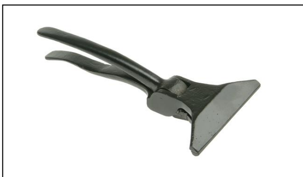
รูปที่ 1.41 แสดงลักษณะของคีมพับตะเข็บด้วยมือ (ที่มา : http://www.ck-supplies.com/index.php?catID=246&prodID=2823 )
