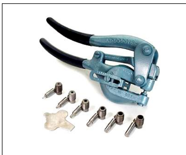
รูปที่ 1.30 แสดงลักษณะของเครื่องเจาะรูด้วยมือ (ที่มา : http://www.knighton-tools.co.uk/acatalog/Punching_Machines.html )
