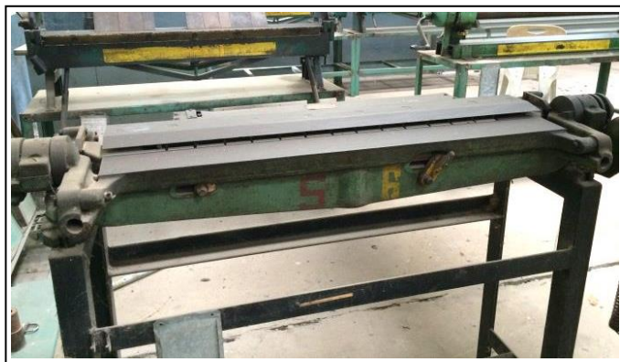
รูปที่ 1.64 แสดงลักษณะเครื่องพับโลหะแผ่นบาร์โฟลเดอร์ (Bending Sheet Metal on a Bar Folder) (ที่มา : พรทิพย์ ชูแสง. 2562.)
