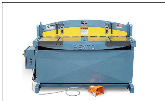
รูปที่ 1.61 แสดงลักษณะเครื่องตัดตรงขับเคลื่อนด้วยมอเตอร์ไฟฟ้า (Power Squaring Shear) (ที่มา : http://www.roperwhitney.com/power-squaring-shears.html )
