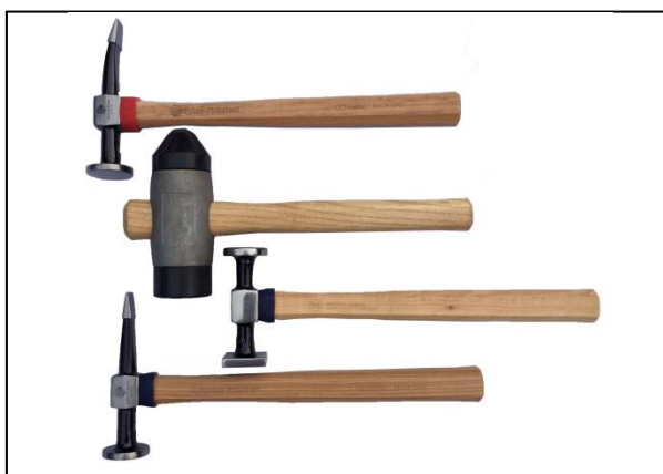
รูปที่ 1.39 แสดงลักษณะของค้อนเคาะขึ้นรูป (ที่มา : พรทิพย์ ชูแสง. 2562.)
