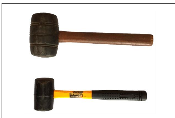
รูปที่ 1.36 แสดงลักษณะของค้อนยาง (ที่มา : พรทิพย์ ชูแสง. 2562)
