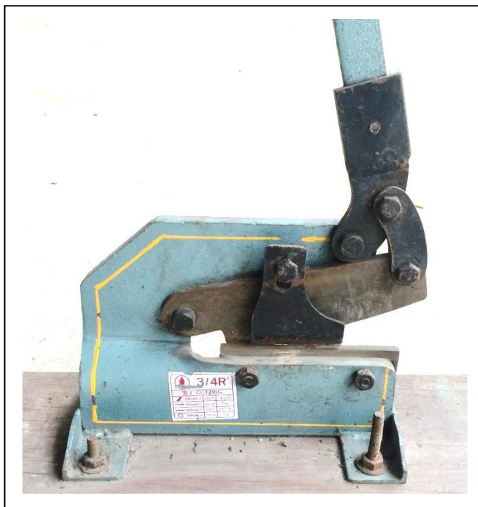
รูปที่ 1.27 แสดงลักษณะของกรรไกรโยก (ที่มา : พรทิพย์ ชูแสง. 2562.)
