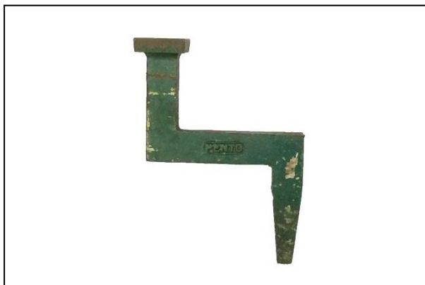
รูปที่ 1.56 แสดงลักษณะเครื่องมือขึ้นรูปออฟเซตสแควร์ (Offset Square Stake) (ที่มา : พรทิพย์ ชูแสง. 2562.)
