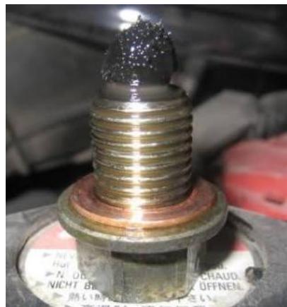
ภาพที่ 8.3 แสดงเศษโลหะที่น้ำมันหล่อลื่นชะล้างมารวมกัน (ที่มา : http://www.toyotanont.com/article_detail.php?article_id=16 )
