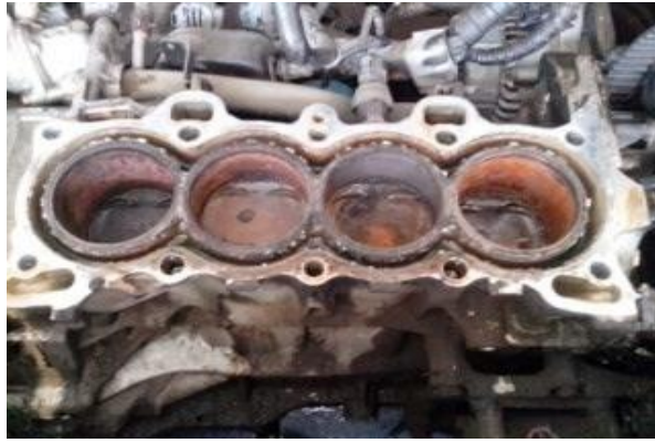
ภาพที่ 8.2 แสดงการเกิดสนิมในเครื่องยนต์ (ที่มา : http://pantip.com/topic/30619987 )
